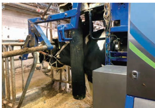
肩のローラーでボックスに誘導
